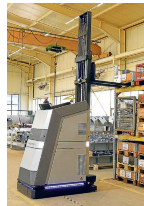
Der Gegengewichtsstapler Paletino kann Paletten und Gitterboxen bewegen.
